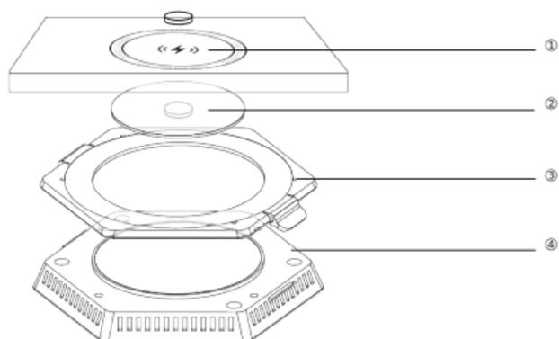
1. Auswählen der Position zum Aufkleben des Aufklebers. Platzieren Sie einen Magneten in der Mitte des Aufklebers.
